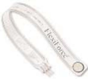
Figura 6.- Fotografía del sensor de presión FlexiForce®.
